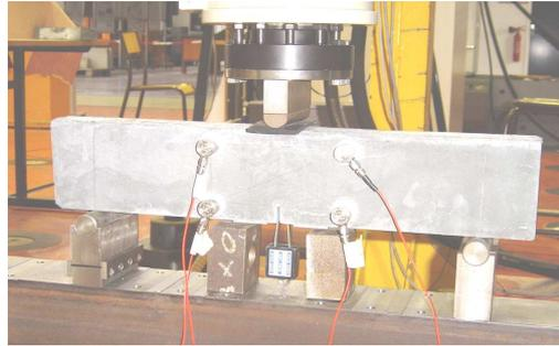
Figure 6 : Instrumentation émission acoustique – Maille de localisation de 140x65 mm<sup>2</sup>.
