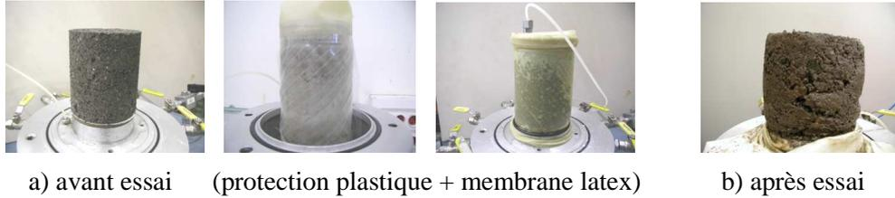
Figure 5: Echantillon « type » avant et après essai triaxial.
