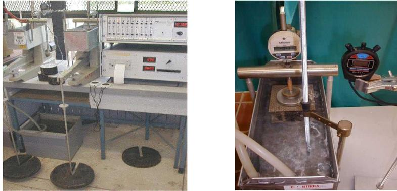
**Figure 1.** Appareillage mis au point pour l'essai de fluage-recouvrance
